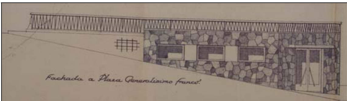
▲ Alzados de la plaza proyectada hacia la Plaza Grande (entonces Generalísimo Franco) y Eusebia de Armas. Véase el revestimiento de piedra exterior que nunca se ejecutó, así como el característico chaflán de Eusebia de Armas y Hnos. González Martín.
