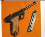
P-08. Desarrollada por Georg Luger sobre el modelo de Hugo Bochard. Tuvo problemas de alimentación. El cierre articulado es delicado. El sistema de disparo es inseguro.
