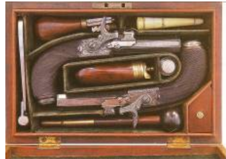
Pareja de pistolas de viaje de Forsyth de 1.815, al amartillar el arma el depósito que está delante del martillo se desplaza, deposita la pólvora en la cazoleta y vuelve a su posición inicial. (16)
