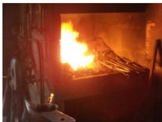
La fragua de Ñoño, eléctrica de ventilador, con extracción de humos. Al lado del hogar la herramienta de la fragua. Sobre el yunque un martillo de bola.
